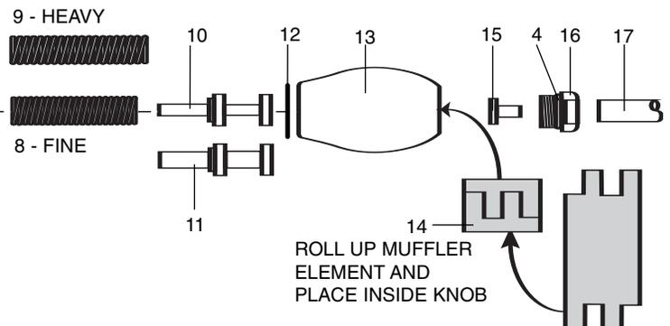
ROLL UP MUFFLER ELEMENT AND PLACE INSIDE KNOB
